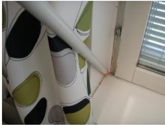
Kuva 75. Tyypillinen vuotokohta laskettaessa merkkiaine ulkoseinärakenteen eristetilaan, ikkunan ja ulkoseinän liitos, B-osa 1krs.
