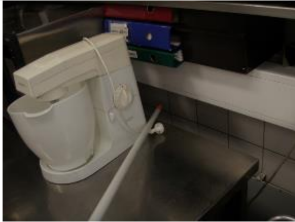
Kuva 81. Tyypillinen vuotokohta laskettaessa merkkiaine ulkoseinärakenteen eristetilaan, sähkökouru, keittiö.
