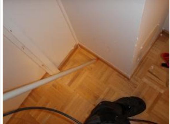
Kuva 86. Tyypillinen vuotokohta laskettaessa merkkiaine alapohjan eristetilaan, esihenkilön toimisto, keittiö.
